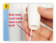
Fädeln Sie die Schnur von oben in den Zuggriff ein. Fädeln Sie anschließend die Beilagenscheibe auf. Achten Sie darauf, dass der Grat des Beilagenscheiben-Loches nach oben zum Griff zeigt (Schutz der Schnur)! Machen Sie dann wieder einen Knoten.
