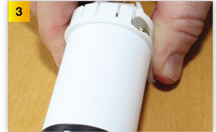
Nehmen Sie den Winflip-Hauptteil vom Fensterflügel ab. Drehen Sie die Ventileinheit auf dem Rohr leicht hin und her (siehe Punkt 1 und 2), damit der innere Dichtring sicher gut sitzt. Achten Sie bei der digitalen Version auf die Kabel, damit Sie diese nicht abreißen!
